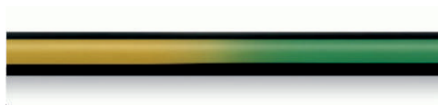
Пример изменения цвета оболочки в зависимости от температуры нагрева
