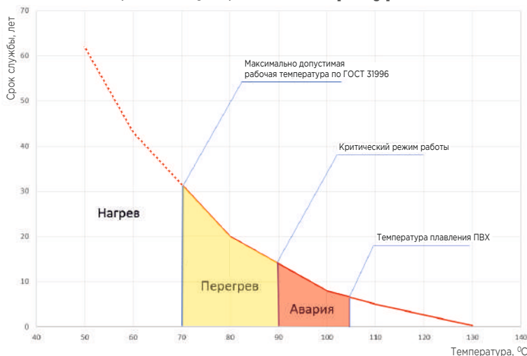
График зависимости срока службы кабеля (изоляция) от температуры
